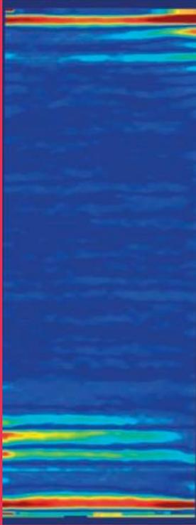
La distorsion optique causée par un manque de planéité du verre est mesurée en comparant l'image réfléchie avec des motifs de référence. Le résultat est fourni en dioptries (où une dioptrie représente la distorsion créée par un rayon de courbure de 2 mètres). Le système a une résolution de 0,002 dioptrie.
